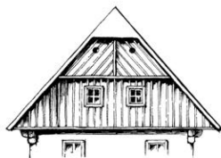
Plošně rozšířený typ štítu, prkna v horním pásu mohou být podle místních zvyklostí rozbíhavá i sblíhavá.
