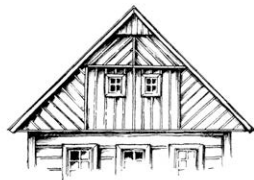
Nejsložitější plošně použitelný štít u střešy s hambálovým krovem.
