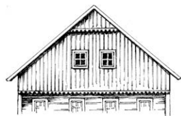
Štíty u střeš s vaznicovým krovem a polopatrem mívaly zpravidla jednoduchý obklad.
