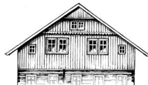
Rozměrné štíty nad polopatrem umožňují osazení většího počtu oken, než štíty střeš s hambálovým krovem.
